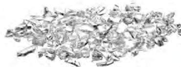
強化玻璃破裂之呈現碎片
