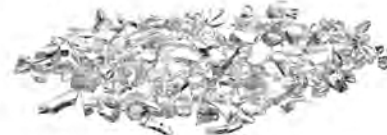
強化玻璃破裂之呈現碎片
