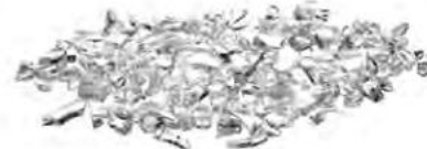
強化玻璃破裂之呈現碎片
