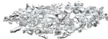
強化玻璃破裂之呈現碎片
