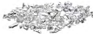
強化玻璃破裂之呈現碎片
